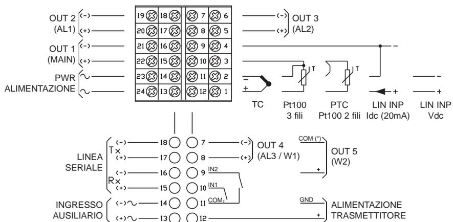
(\*) COM è sul morsetto 7 per uscita OUT4 di tipo continuo (W1).
