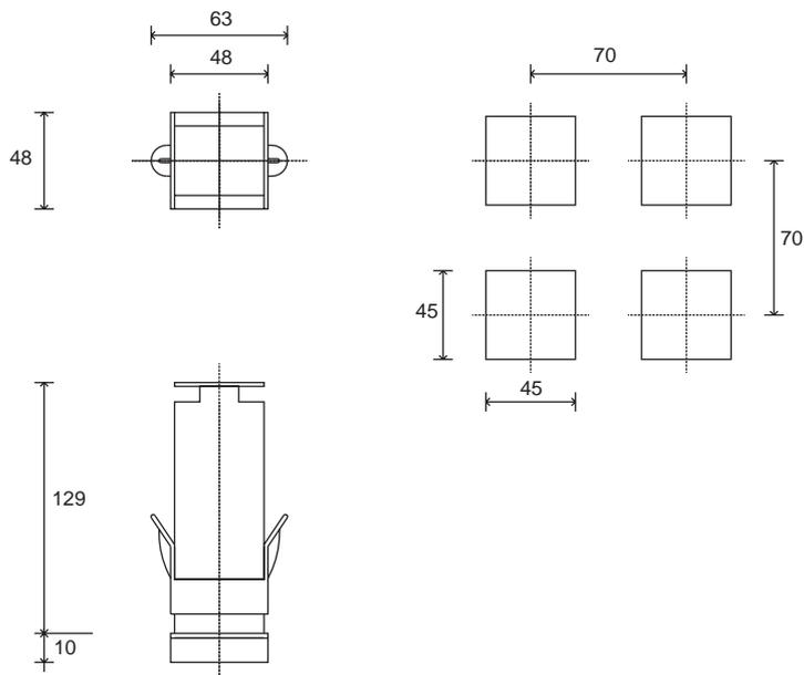
Dimensioni di ingombro: 48x48mm (1/16DIN) profondità 129mm
