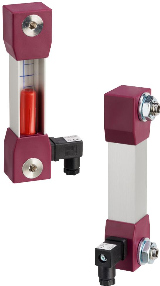
**Livelli Visivi danno la possibilità di controllare in ogni istante il livello del liquido in modo chiaro e preciso.** Il principio utilizzato è quello dei vasi comunicanti: il liquido attraversa il livello per mezzo di viti cave, rivelando all'utente il preciso punto del liquido all'interno del serbatoio.
