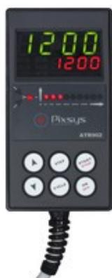
Programmatore palmare con connettore multipolare, singolo Loop di controllo. Consente la programmazione di 15 cicli/programmi che possono prevedere fino a 18 step/segmenti, tutti liberamente configurabili dall'utente come salita/mantenimento/discesa. Modalità di programmazione e visualizzazione del ciclo di lavoro semplice ed intuitiva anche per l'operatore non esperto.
