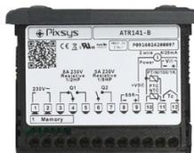
Questo **regolatore di temperatura e di processo 32x74** con **display a 4 cifre** è caratterizzato da **elevata configurabilità**, che si traduce in un ridotto numero di codici prodotto. L'ingresso è programmabile per sensori di temperatura, termoresistenze e termocoppie ma anche per trasmettitori di pressione, **sensori di umidità e di flusso**.
