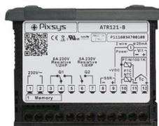
Questo **regolatore 32x74** è caratterizzato da elevata configurabilità, che si traduce in un ridotto numero di codici prodotto. L'ingresso è programmabile per **sensori di temperatura**, termoresistenze e termocoppie ma anche per trasmettitori di pressione, sensori di umidità e di flusso.
